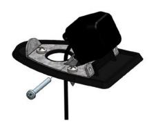
Führen Sie das Kabel durch und versiegeln Sie das Loch. Befestigen Sie anschließend die Kamera mit der mitgelieferten Schraube an der Montageplatte. Setzen Sie die Schraube nur an - aber schrauben Sie sie noch nicht fest!
