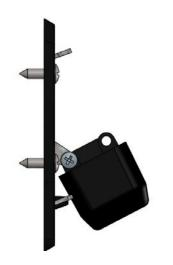
Justieren und richten Sie den gewünschten Blickwinkel, soweit möglich der ausgewählten Montagehöhe angepasst, ein. Nachdem Sie den für Ihre Anwendung korrekten Winkel bestimmt haben, fixieren Sie das Gehäuse in dem Sie die Schraube vorsichtig festdrehen.
