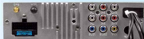
Die Cinchansgänge liefern knappe 5 V Spannung
