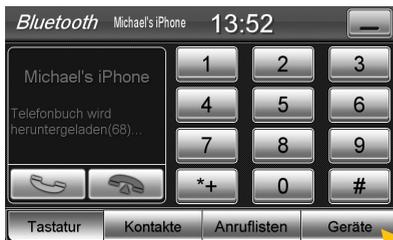
Zum Trennen (Entkoppeln) der beiden Bluetooth-Geräte, tippen Sie auf „Geräte“.
