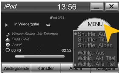
Achten Sie darauf, dass der iPod™ korrekt per beiliegendem Anschlusskabel mit dem Gerät verbunden ist. Dieses Anschlusskabel ermöglicht auch den Anschluss eines iPhone™ (bis 4S), um dessen integrierte Audio-Wiedergabe zu nutzen. Die Akku-Ladefunktion erfolgt sobald das Gerät eingeschaltet ist. Bei älteren iPod™-Modellen kann es vorkommen, dass diese nach dem Ausschalten des Geräts nicht erkannt werden. Klemmen Sie in diesem Fall den iPod™ ab und wieder an.
