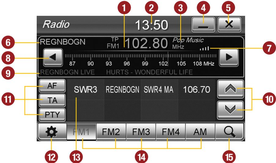
1. Zeigt das aktuelle Frequenzband sowie die aktuelle Senderfrequenz. Kann zur schnellen Sendersuche direkt angetippt werden.
