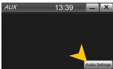
Mit dem AUX-Werkseingang (nicht bei Media In-Box) ist es möglich, ein Audio-Wiedergabegerät (MP3-Player, Mobiltelefon etc.) über das Gerät und das angeschlossene Soundsystem laufen zu lassen.
