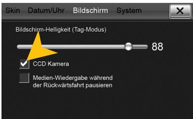
Aktivieren Sie unter „CCD Kamera“ die optional an das Gerät angeschlossene Rückfahrkamera. Sobald der Rückwärtsgang eingelegt wird, wird die Video-Übertragung der Kamera automatisch auf dem Bildschirm eingeblendet.
