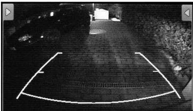
Sollte eine optionale Rückfahrkamera installiert worden sein, wird sobald der Rückwärtsgang eingelegt wurde, automatisch das Bild der Kamera auf dem Bildschirm gezeigt (Siehe Einstellungen auf S.28). Dies geschieht auch dann, wenn das Gerät ausgeschaltet ist. Nach dem der Rückwärtsgang wieder ausgelegt wurde, startet das Gerät wieder die zuvor benutzte Anwendung oder Funktion.
