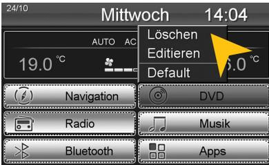
Um ein Bedienfeld neu zu belegen, berühren Sie dieses etwa 2-5 Sekunden um in das Bearbeitungs Menü des Felds gelangen. Tippen Sie auf „Löschen“, um das Bedienfeld zu entfernen.
