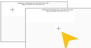
Tippen Sie mit dem beiliegenden Stylus-Markierstift auf das „+“. Dieses wird dann an eine andere Stelle verschoben. Tippen Sie dann abermals auf das „+“ und wiederholen Sie diesen Vorgang bis die Kalibrierung abgeschlossen ist. Bestätigen Sie die Kalibrierung und das Betriebssystem übernimmt die neue Einstellung.
