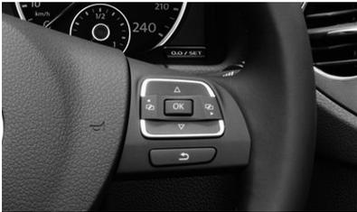
Das Gerät unterstützt eine Steuerung per serienmäßigem Multifunktionslenkrad. Die Steuerungstasten entsprechen in Ihrer Funktion weitestgehend den Bedientasten am Gerät. Die Funktionsweise kann von Automodell zu Automodell leicht variieren und je nach Modell/Baujahr eingeschränkt sein.
