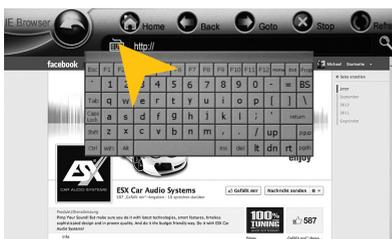
Mit einem separat erhältlichen 3G-USB-Stick und einer aktivierten SIM-Karte (3G/UMTS) ist es möglich, die „Internet“-Funktion zu verwenden. Stecken Sie dazu den Stick an den USB-Anschluss des Geräts und folgen Sie den Installationsanweisungen des jeweiligen Sticks. Halten Sie dazu die Zugangsdaten für den Internetzugang bereit.
