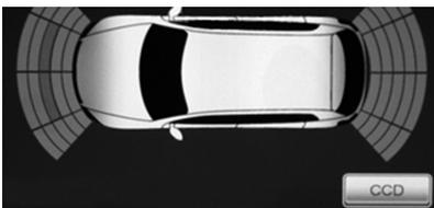
Sollten in Ihrem Fahrzeug serienmäßig Parksensoren installiert sein, wird eine Abbildung des Fahrzeugs von oben auf dem Bildschirm gezeigt. Darauf wird die augenblickliche Einpark-situation grafisch dargestellt. Diese Funktion ist modellabhängig und wird nicht bei allen Fahrzeugen unterstützt.
