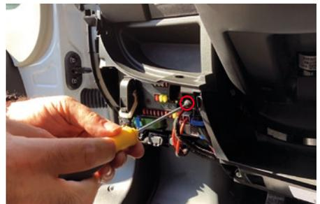
VNA-BTBOX\*-Anschluss (optional): Entfernen Sie den Deckel vom Sicherungskasten. Lösen Sie die Schraube.
