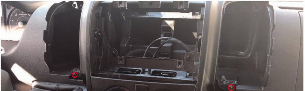
Das Cockpit müsste jetzt so aussehen. Lösen Sie die 2 Schrauben.
