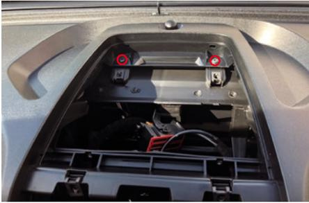
Lösen Sie die 2 Schrauben darunter.
