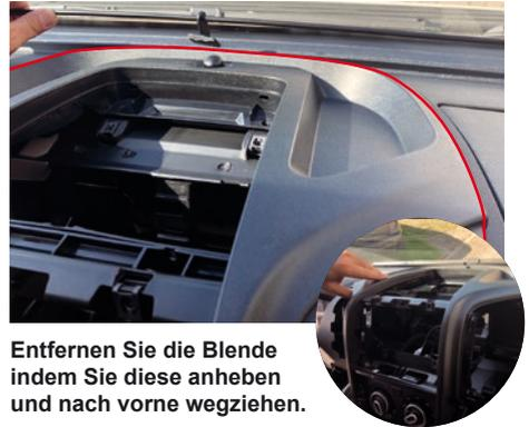
Entfernen Sie die Blende indem Sie diese anheben und nach vorne wegziehen.
