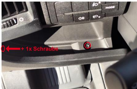
Lösen Sie die Schrauben auf der linken Seite unterhalb des Lenkrads.
