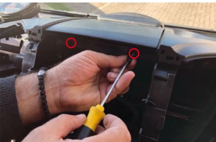
Befestigen Sie die 2 Schrauben auf der Vorderseite.
