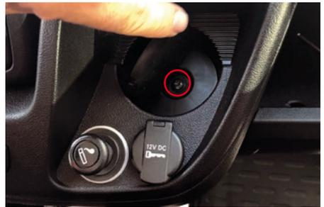
Heben Sie die Gummiablage an und entfernen Sie die Schraube darunter.
