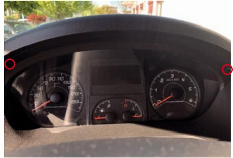
Lösen Sie die 2 Schrauben.
