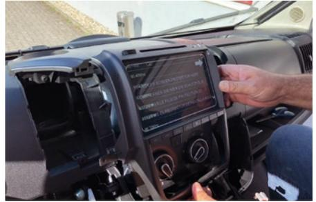
Schieben Sie das ESX Gerät in den Schacht.
