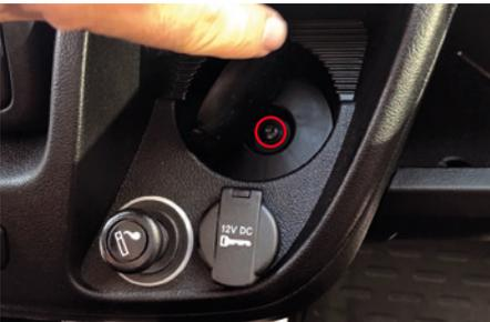
Befestigen Sie die Schraube und legen Sie die Gummiablage wieder ein.
