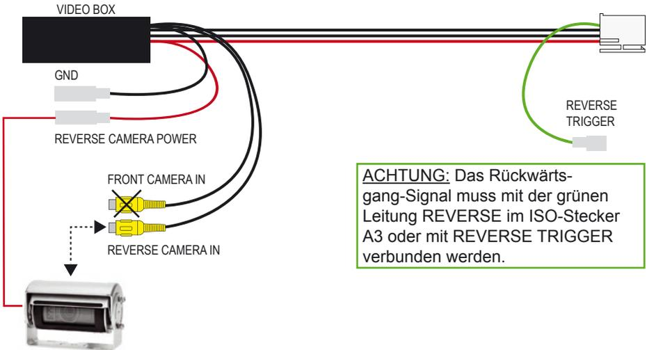
**ACHTUNG:** Das Rückwärts-gang-Signal muss mit der grünen Leitung REVERSE im ISO-Stecker A3 oder mit REVERSE TRIGGER verbunden werden.
