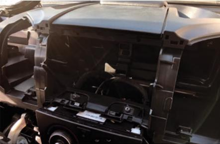
Legen Sie das Ablagefach wieder ein und heben es an, danach befestigen Sie die 2 Schrauben.
