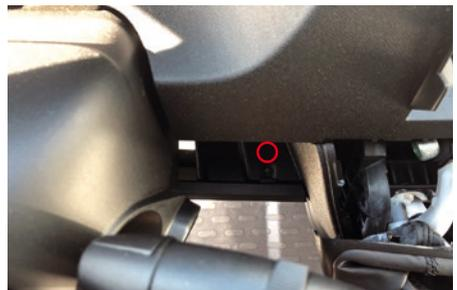
Lösen Sie die Schraube auf der rechten Seite unterhalb des Lenkrads.
