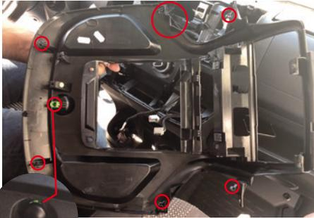
Entfernen Sie alle markierten Clips von der Originalblende und stecken diese auf die mitgelieferte Blende.
