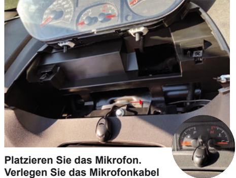
**Platzieren Sie das Mikrofon.** Verlegen Sie das Mikrofonkabel wie abgebildet.
