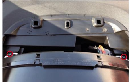
Lösen Sie die 2 Schrauben und legen Sie das Tachodisplay oben ab (Stecker können dran bleiben).
