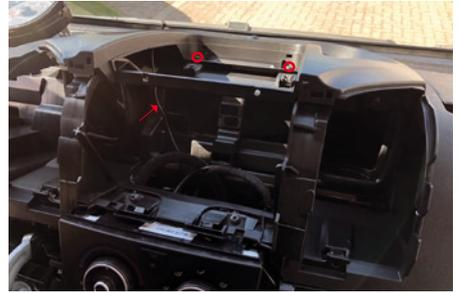
Achten Sie dabei auf das GPS-Kabel und befestigen Sie die 2 Schrauben. Führen Sie dann das Kabel der GPS-Antenne zum Gerät und verbinden Sie es mit der GPS-Buchse wie auf Seite 14 beschrieben.
