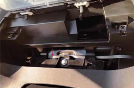
**VNA-BTBOX\*-Anschluss (optional):** Verlegen Sie das Anschlusskabel.
