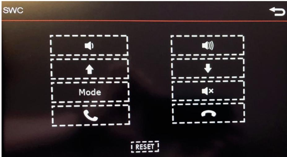
Drücken Sie zunächst zur Vorbereitung die Taste „Reset“. Danach drücken Sie auf die gewünschte Funktion und anschließend auf die Taste am Multifunktionslenkrad über welche diese Funktion gesteuert werden soll. Nachdem Sie eine Funktion erfolgreich zugewiesen haben, wird das Feld markiert.
