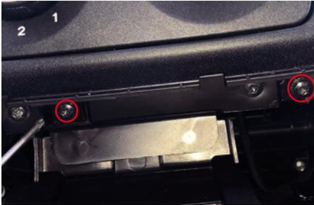
Lösen Sie die 2 Schrauben.
