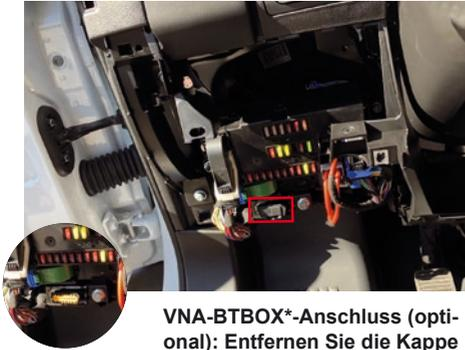
**VNA-BTBOX\*-Anschluss (optional):** Entfernen Sie die Kappe des Steckers.
