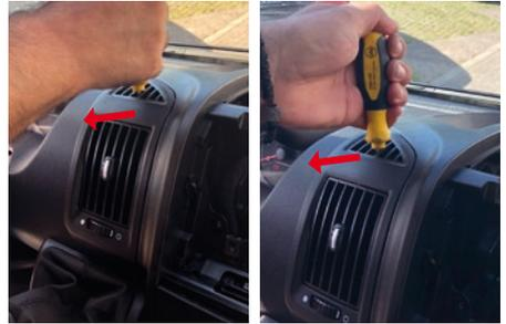
Entfernen Sie die Lüftungsschächte links und rechts mit einem Schraubenzieher und Hebelwirkung wie abgebildet.
