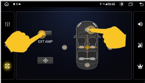
In diesem Menü können Sie die Balance zwischen den rechten und linken Lautsprechern sowie das Fading zwischen den vorderen und hinteren Lautsprechern einstellen. Drücken Sie dazu auf die Pfeiltasten um die gewünschte Position einzustellen.
