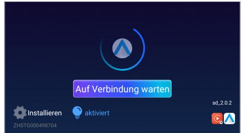
Schließen Sie das Smartphone mit dessen Ladekabel an einem der USB-Anschlüsse an. Die Verbindung wird dann automatisch hergestellt. Falls dann “Sie können während der Fahrt keine Videos sehen“ erscheint, beachten Sie dazu den Hinweis rechts unten.
