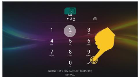
Wird das Gerät ausgeschaltet, müssen Sie wie bei einem Smartphone nach jedem Neustart den PIN-Code der SIM-Karte erneut eingeben. Siehe dazu Hinweis unten.
