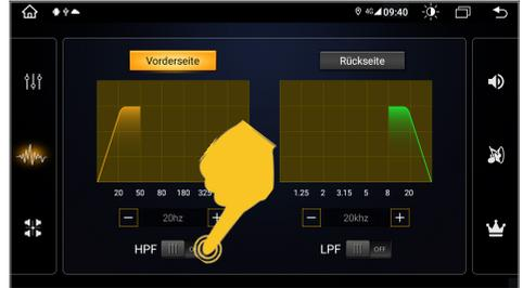
In diesem Menü können Sie einen Hoch- und/oder Tiefpassfilter für das Audiosignal aktivieren. Bringen Sie den jeweiligen Schalter in die Position **ON** und wählen Sie die gewünschte Trennfrequenz aus.
