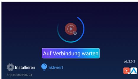
Aktivieren Sie zunächst die WLAN-Funktion auf dem Smartphone. Verbinden Sie dann das Smartphone über Bluetooth mit dem ESX Gerät, falls noch keine aktive Bluetooth-Verbindung besteht. Im Bluetooth-Menü Ihres Smartphones müssen Sie dann noch sicherstellen, dass dort die Funktion **CarPlay** aktiviert ist.
