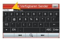
Frequenzdirekteingabe: Diese Funktion dient nur zur Prüfung der lokalen Empfangssituation oder zum Testen eines einzelnen Frequenzblockes. Tragen Sie dazu in das weiße Feld die gewünschte Frequenz (nur Zahlen und Punkt) ein und bestätigen Sie die Eingabe durch Tippen auf die Lupe.
