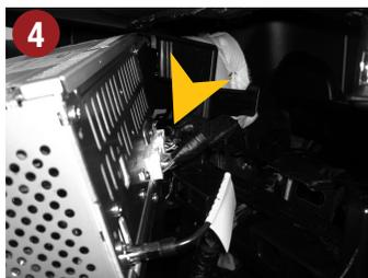
4.) Ziehen Sie es dann vorsichtig aus dem Schacht und entfernen Sie alle Kabelstecker vom Gerät.
