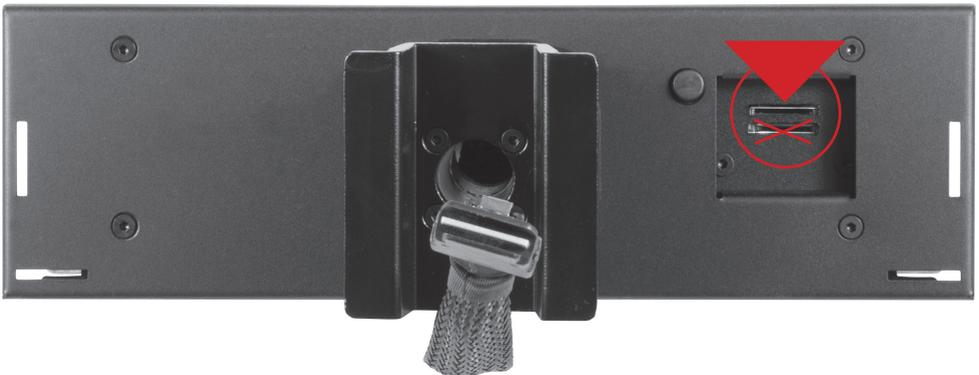
Hier können Sie die MicroSD-Karte der Navigationssoftware einschieben. Bitte verwenden Sie nur den oberen MicroSD-Kartenslot. Der untere MicroSD-Kartenslot ist nur für Medien geeignet.
