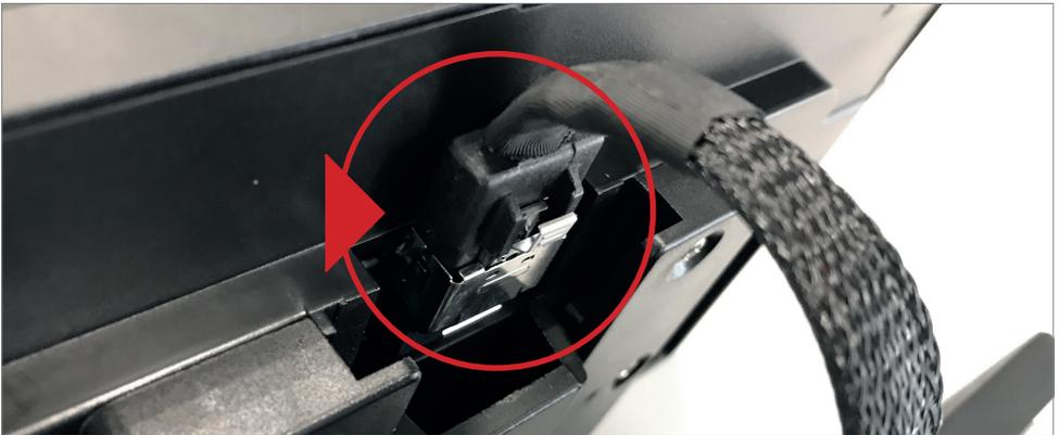
Verbinden Sie den Stecker des Monitors mit dem Hauptgerät.
